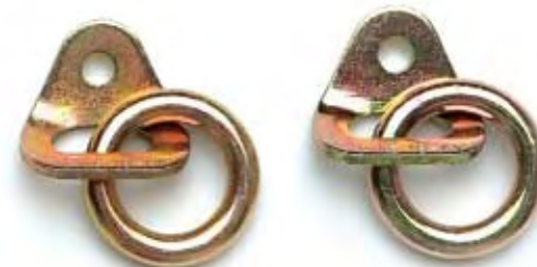
Plaqueta Fixe 2 Bicromatada. Peso: 140 g. Resistencia: 18 kN.
